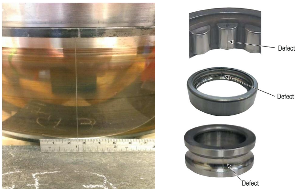
Rys. 2.4. Przykład 2; łożyska z intencjonalnie wprowadzonymi uszkodzeniami [26, 88]
