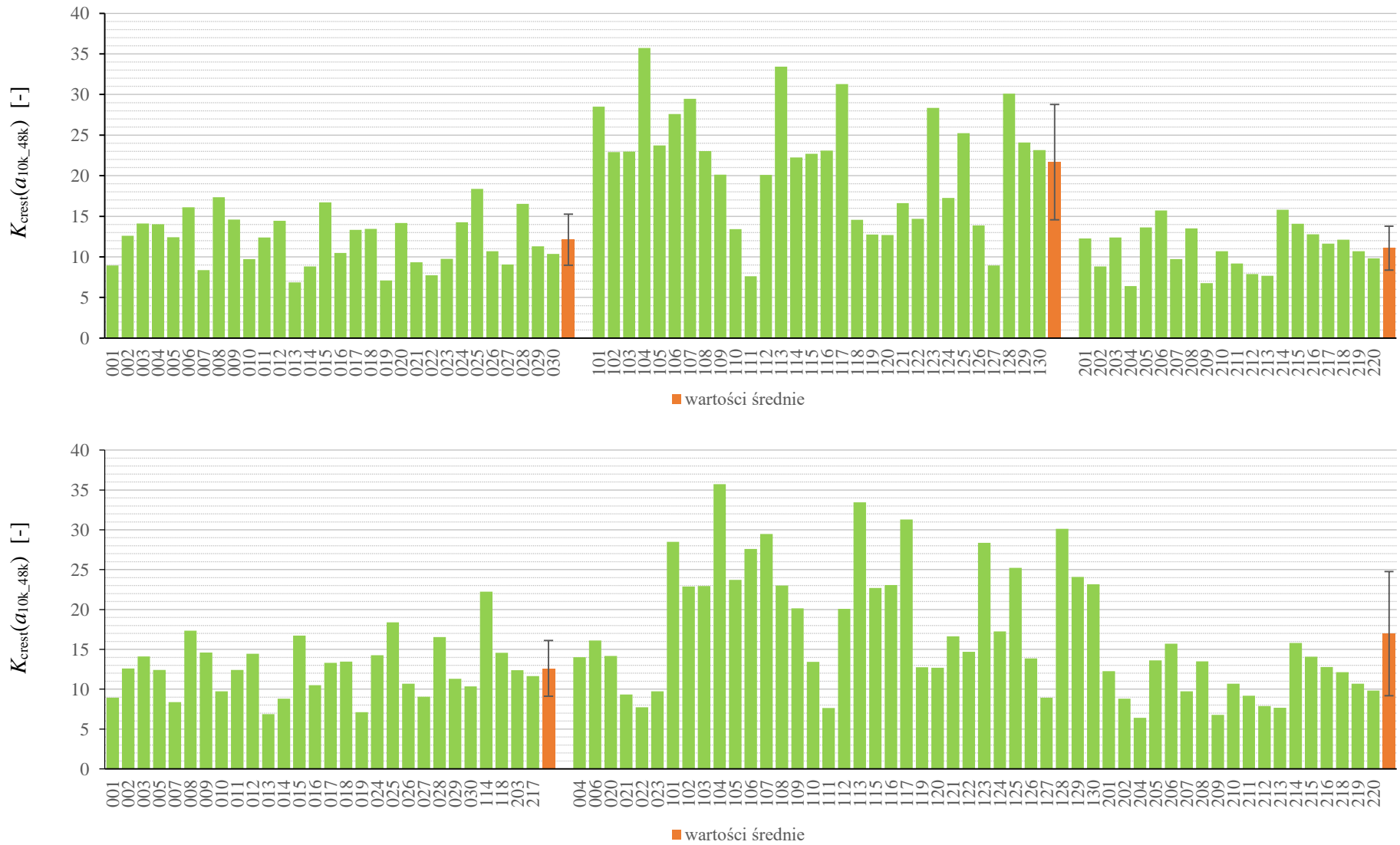
Rys. Z4.53. Wyniki parametryzacji sygnału przyspieszeń drgań – współczynnik szczytu wyznaczony w paśmie od 10 kHz do 48 kHz w grupach: po pierwotnej klasyfikacji z wykorzystaniem szumomierza (u góry) i po wtórnej klasyfikacji na stanowisku referencyjnym w PBF Kraśnik S.A. (na dole)
