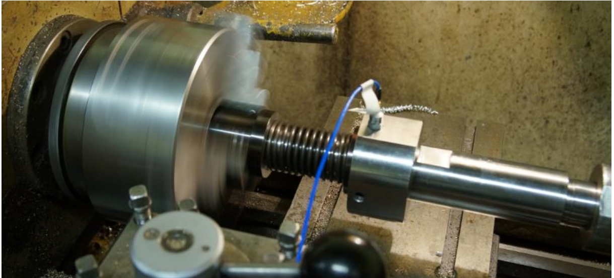
Rys. 3.16. Widok stanowiska do badań wpływu obciążenia osiowego na drgania generowane przez łożyska stożkowe podczas prowadzenia testu [127]
