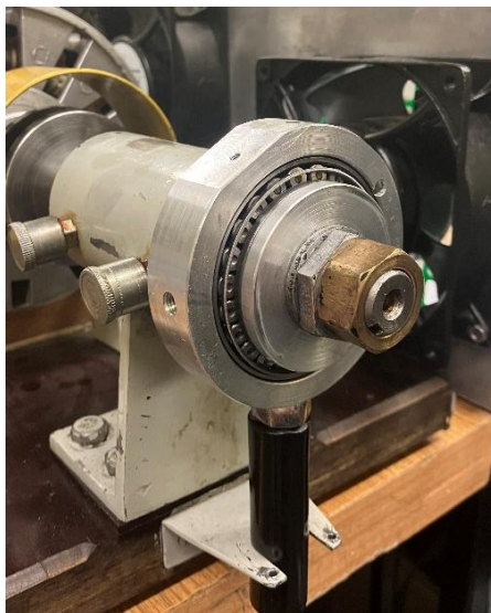
Rys. 4.3. Łożysko stożkowe 513-716A zamontowane na stanowisko LDS [fot. autor]
